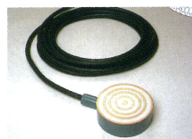
路面水分検出機・水分電極
